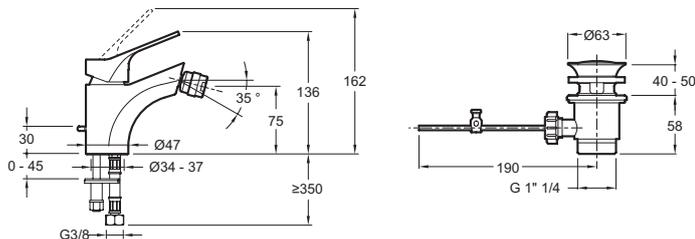
Спецификация продукта : Однорычажный смеситель для биде. E75763-4. Коллекция : BRIVE. ВЕС : 1.4 кг. МАТЕРИАЛ : N/A. ТИП УСТАНОВКИ : 1 отверстие. НОРМЫ И ПРАВИЛА : ACS : 15 ACC LY 472. TYPE : Однорычажный. DÉBIT (L/MN SOUS 3 BARS) : 5 л/мин. HAUTEUR TOTALE DU ROBINET (MM) : 136. SAILLIE DU BEC (MM) : 103. RACCORDS : С гибкой подводкой. MÉCANISME : Дисковый картридж.
